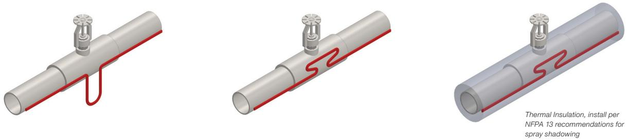
**FIGURE 2: SPRINKLER HEAD WITH SPRIG**
