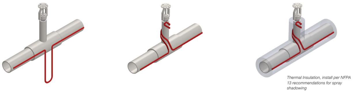
**FIGURE 3: DRY PENDANT SPRINKLER IN FREEZERS**
